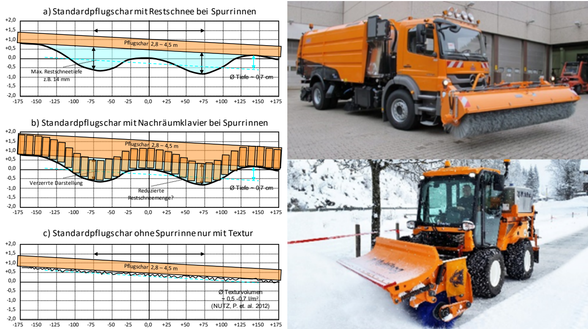
Abbildung 104: Untersuchung von Querebenheit für Beurteilung von Räumequipment
