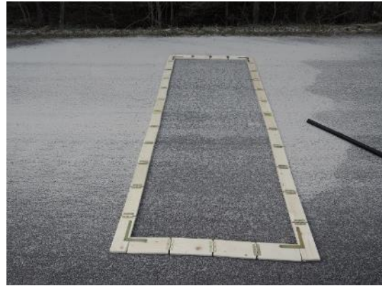
Abbildung 70: Rahmen zur Ermittlung der Restmengen bzw. der Räumleistung
